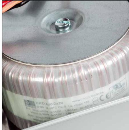
Der massive Ringkerntrafo bildet den Rückhalt der stabilen Stromversorgung
