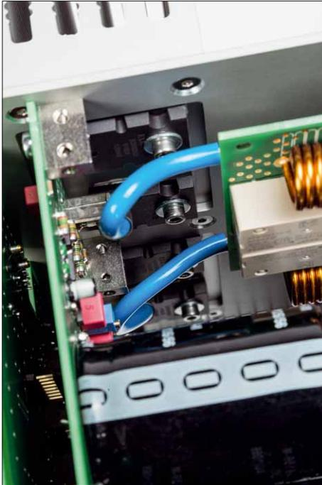
Vier Doppel-Lateral-MosFets stellen die statische Ausgangsleistung des Verstärkers bereit
