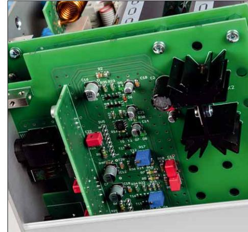
Eingangsseitig arbeitet Linnenberg mit einer Instrumentenverstärkerkonfiguration
