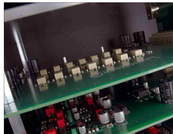
Das Widerstandsnetzwerk der Vorstufe entlohnt jede Änderung der Lautstärke mit einem wunderbar mechanischen Klicken
